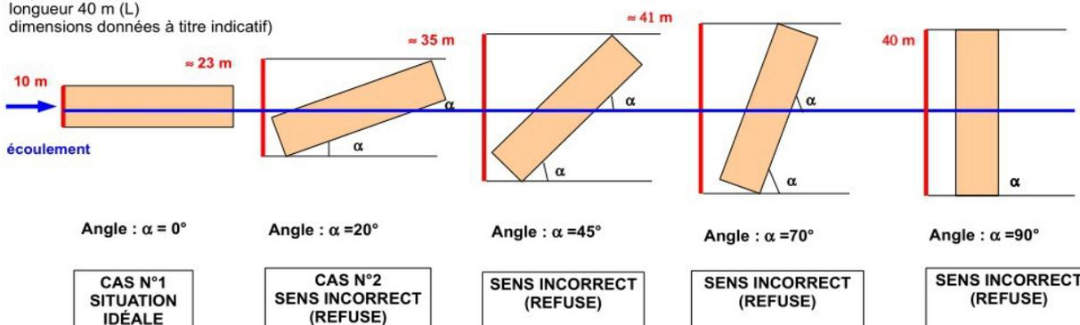
À titre indicatif, le permis sera refusé dès lors que la prise à l'écoulement est deux fois supérieure à la situation « idéale » (cas n°1 : plus petite dimension perpendiculaire à l'écoulement).
